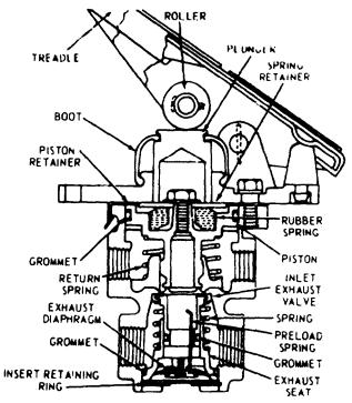
Figure 9C-3. Treadle Valve (38Z225)
