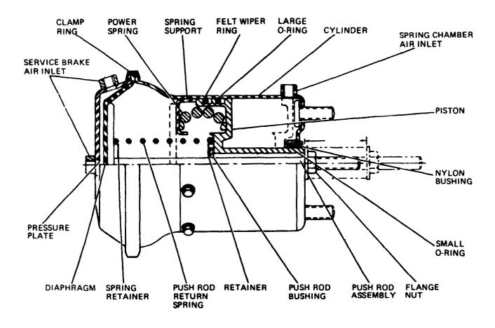
Figure 9D-3. Maxibrake Chamber 38Q18)
