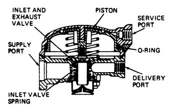
Figure 9C-6. Relay Valve (36Z650)
