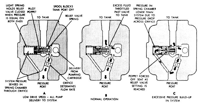
Figure 10B-2. Relief Valve Operation
